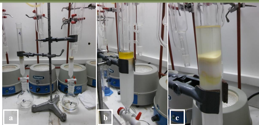
Figura V.3.2. Columnas de clean-up (sílica-alúmina) listas para sembrar la muestra; b: Sembrado de la muestra y c: Elución de la muestra en columna.
